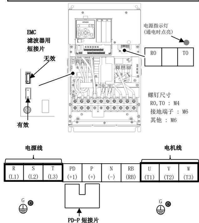
※利用短接片，可以进行 EMC 滤波器的有效/无效切换。
