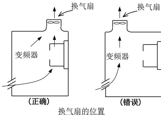
※换气扇位于变频器正上方时，有可能会有灰尘落入。安装时需要将变频器适当移动调整。
