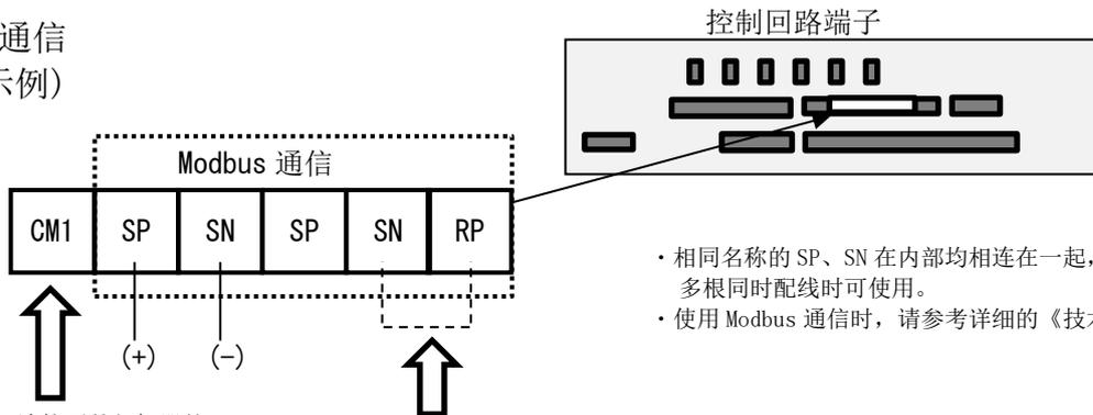
请将 CM1 连接至外部机器的 SG(信号地线)。
