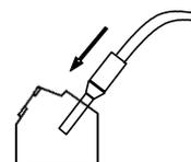
插入电线并用一字起拧紧螺丝即被固定
