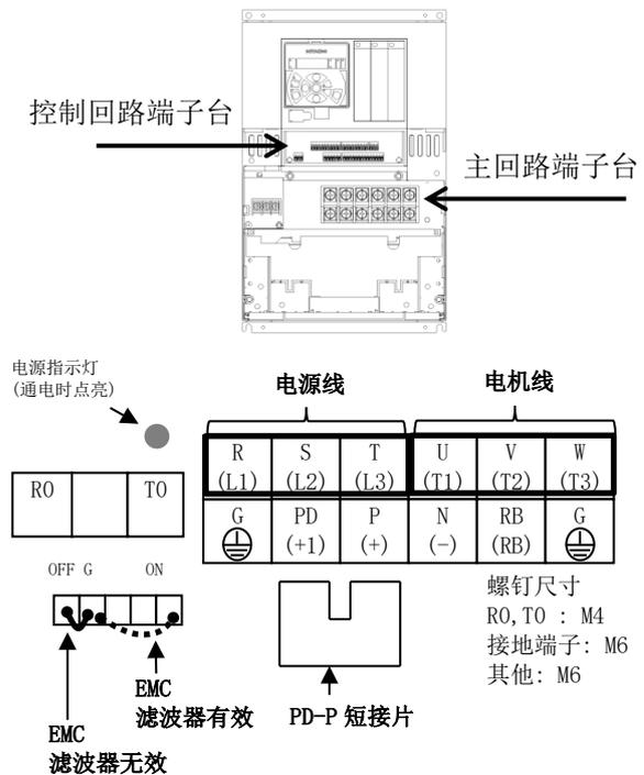
※利用短接片，可以进行 EMC 滤波器的有效/无效切换。
