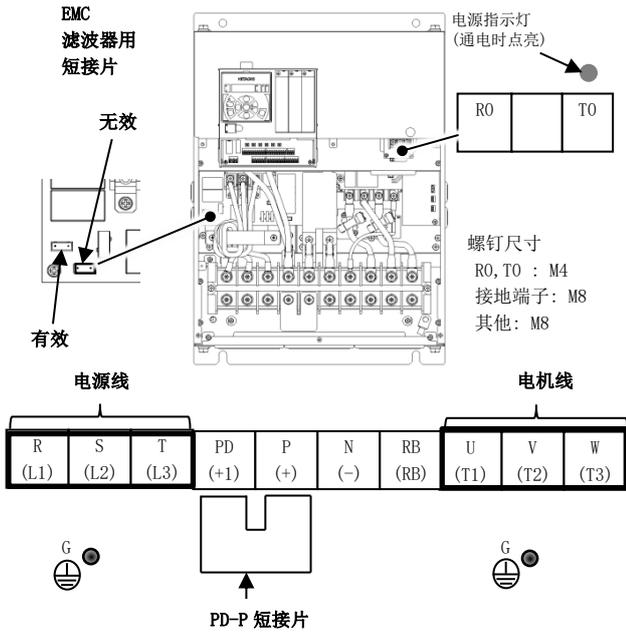
※利用短接片, 可以进行 EMC 滤波器的有效/无效切换。
