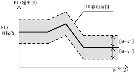
• 限制 PID 的输出范围。[AH-71]=0.00 时限制无效。
