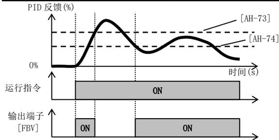
• 如果 PID 反馈超出 OFF 门限 [AH-73]，则输出端子功能 046 [FBV] 为 OFF。
