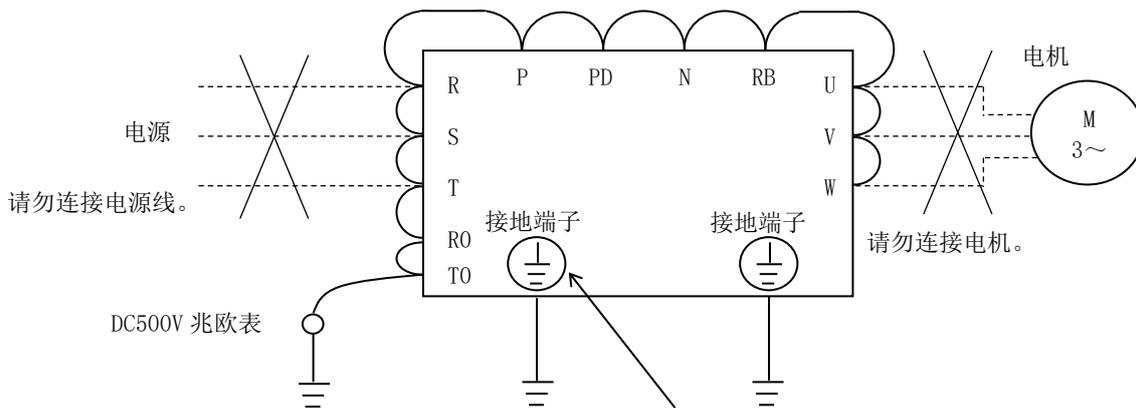
请务必将内置滤波器功能切换用短接片取下。\*1)
