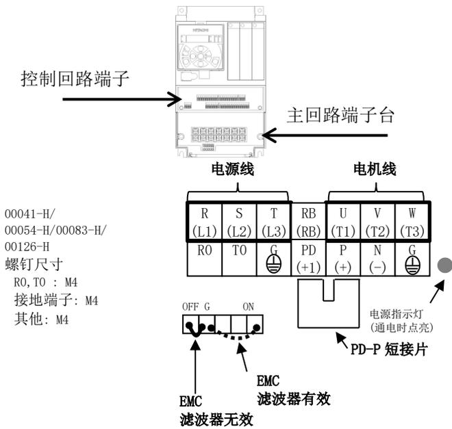
※利用短接片，可以进行 EMC 滤波器的有效/无效切换。
