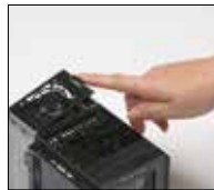
拆下变频器顶部盖板
